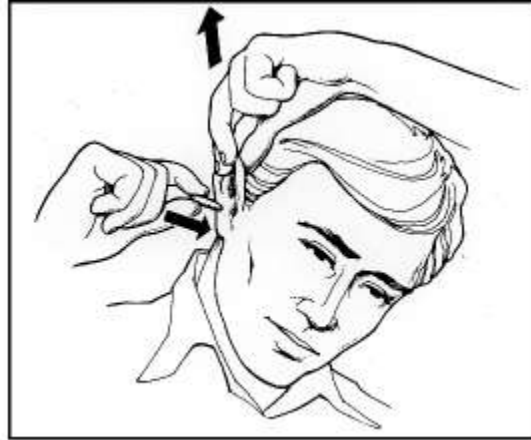
Figura 7. Colocación correcta del tapón estándar, halando la oreja hacia arriba y hacia atrás, e insertando el tapón auditivo.
